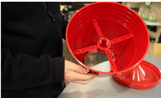
3. Das Kreuz in den Trichter einklippen
