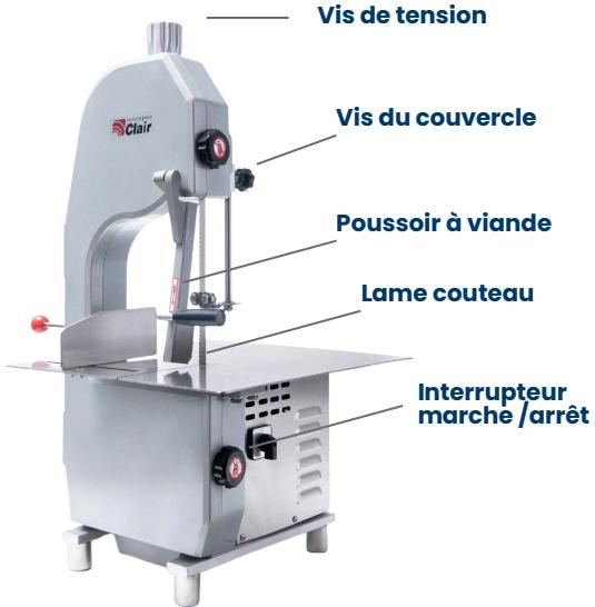
Lors de ce test de fonctionnement, vérifiez que la lame tourne dans le sens des aiguilles d'une montre. Une fois cette vérification effectuée, serrez la vis de tension du ruban de scie située sur le dessus de l'appareil jusqu'à ce que le son de la lame indique une tension adéquate. La scie est alors prête à être utilisée après un nettoyage obligatoire.
