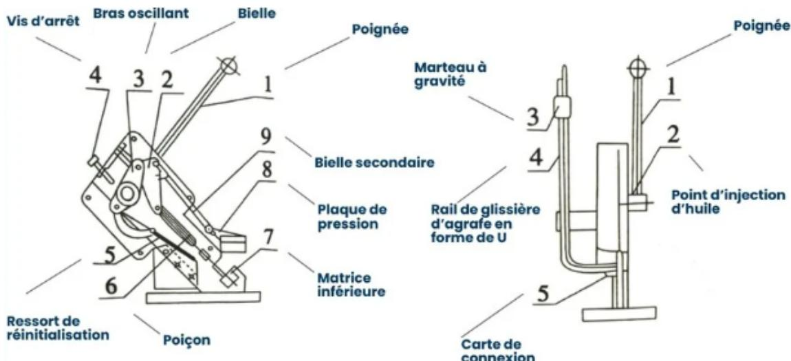
La clippeuse, également appelée machine à encliquer, est un équipement spécialisé destiné au scellement et au poinçonnage des saucisses de jambon, ainsi que de divers produits alimentaires tels que les fruits, les pomelos ou d'autres denrées.
